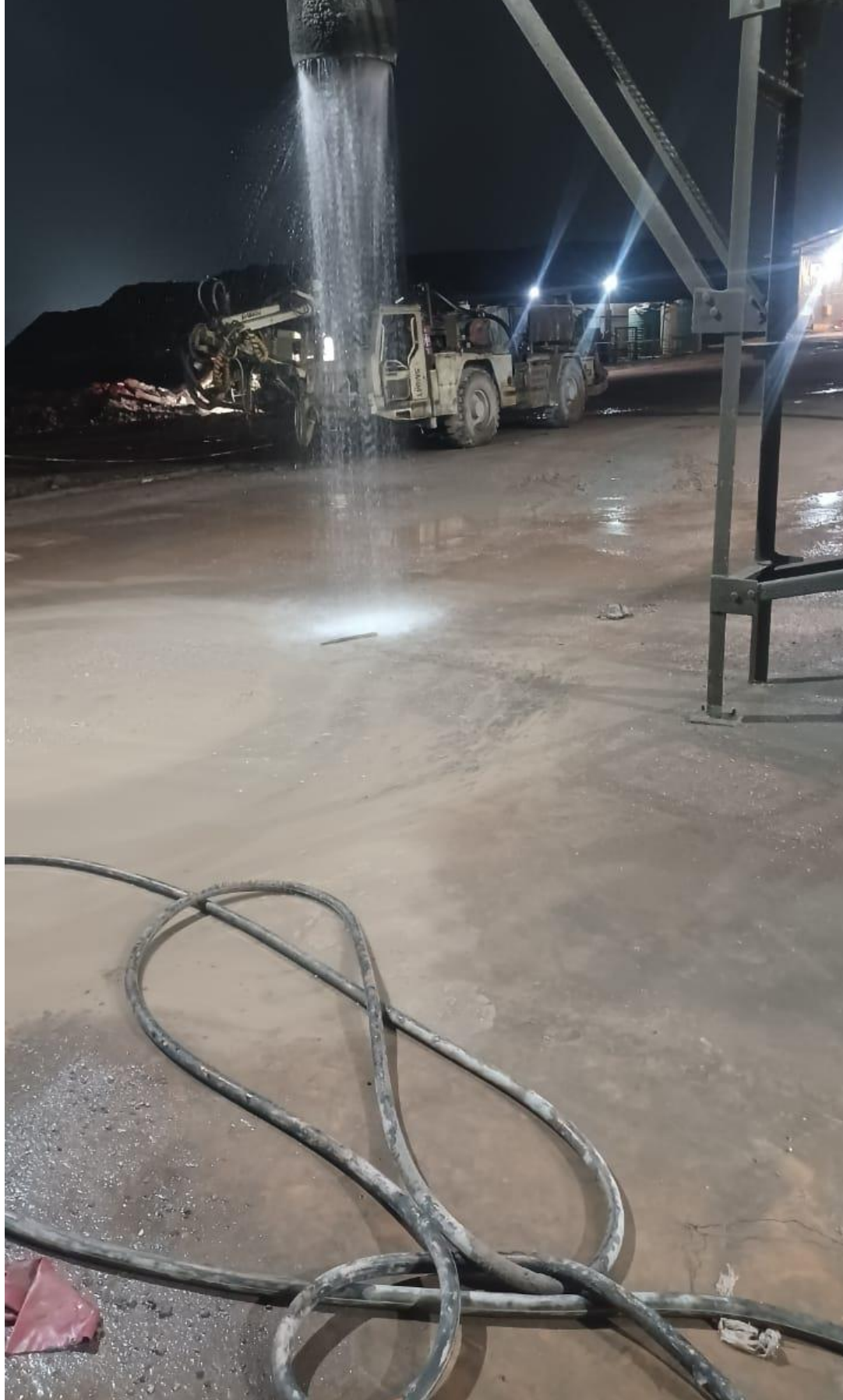
Figure III.13. Niveau du mélange d'eau dans le camion transporteur
