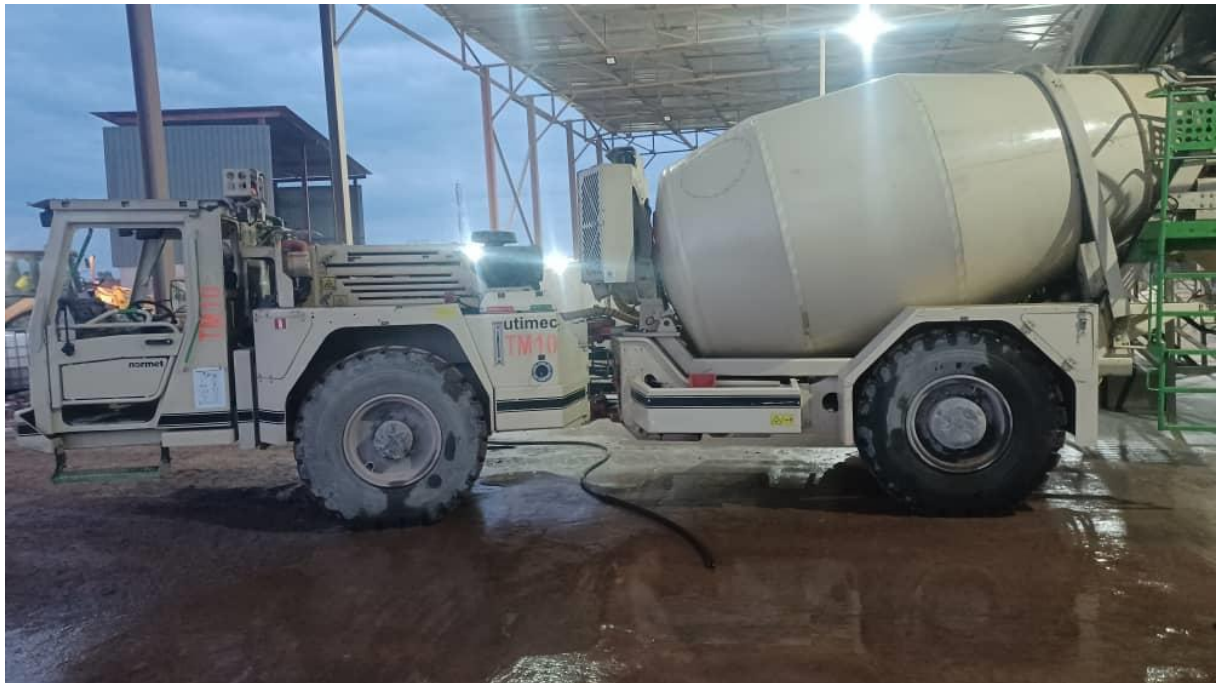
Figure III.11. Camion avec lance pour projeté le béton (spraymec)
