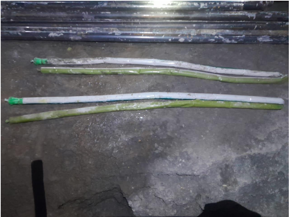
Figure III.4. Résine pour serrer les boulons
