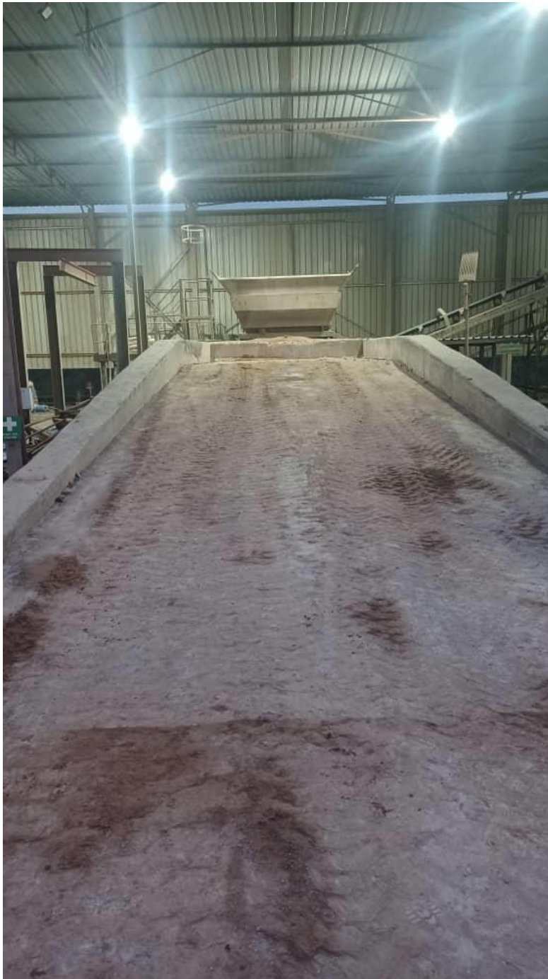
Figure III.10. Trémie réceptrice pour le mélange
