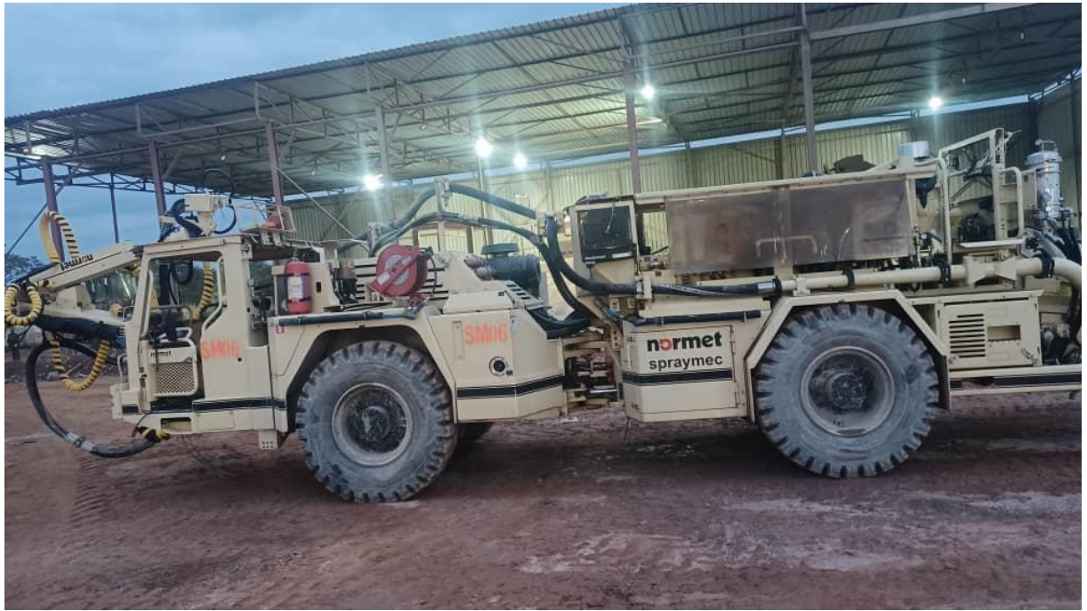
Figure III.11. Camion avec lance pour projeté le béton (spraymec)
